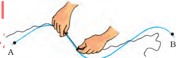
चित्र 10.10 धागे की सहायता से किसी वक्र-रेखा की लंबाई मापना
